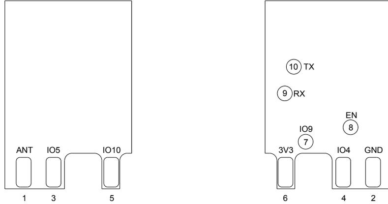
图 2: 管脚布局（顶视图和底视图）
