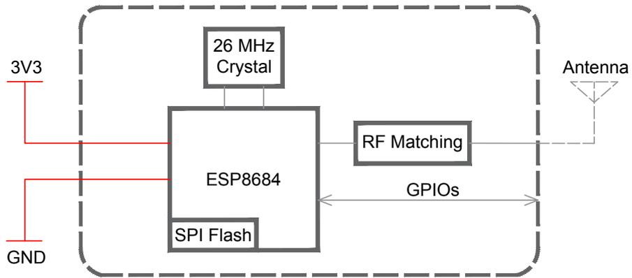
图 1: ESP8684-WROOM-07 功能框图
