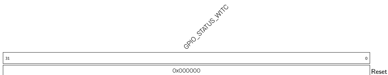
Register 6.29. GPIO_STATUS_W1TC_REG (0x004C)
