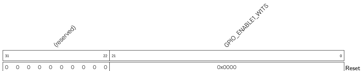
Register 6.13. GPIO_ENABLE1_W1TS_REG (0x0030)
