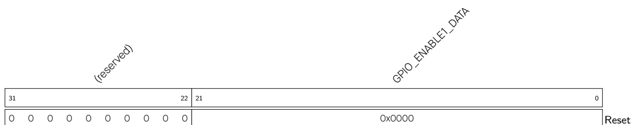
Register 6.12. GPIO_ENABLE1_REG (0x002C)
