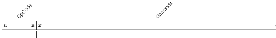
图 2-6. ULP-FSM 协处理器的指令格式
